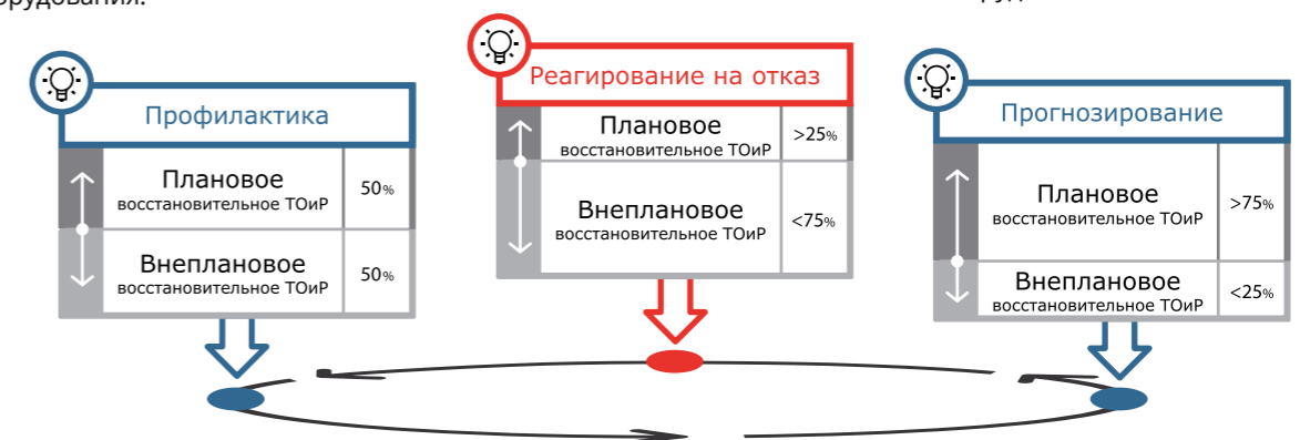
Рис. 1. Трансформация подходов к организации технического обслуживания и ремонта
